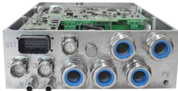
Höchste Leistungsdichte: 250 kW bei nur 10 l Volumen
